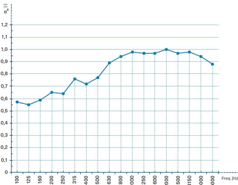
COEFFICIENTE DI ASSORBIMENTO ACUSTICO PER APPLICAZIONI AVVITATE SU ORDITURA RIBASSATA
