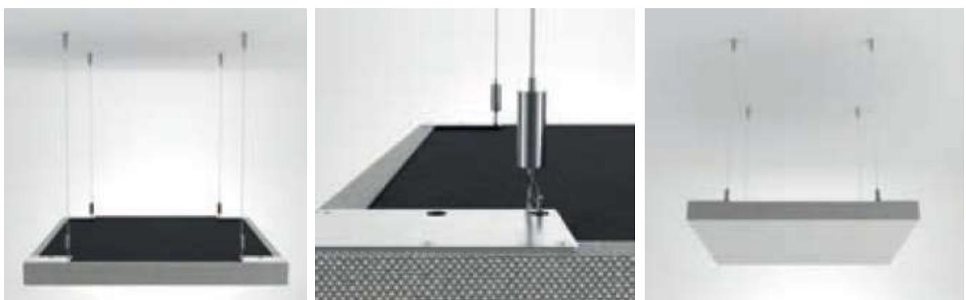
Ciascun pannello della linea Absorber PRO si può installare in sospensione a soffitto mediante cavi in acciaio plastificati e morsetti con gancio, forniti nel kit di fissaggio. Per questo tipo di installazione, che permette di attivare la fono-assorbenza su ambo i lati dei pannelli, questi sono dotati di apposite piastre con fori fissate sulla cornice perimetrale del pannello in corrispondenza degli angoli.
