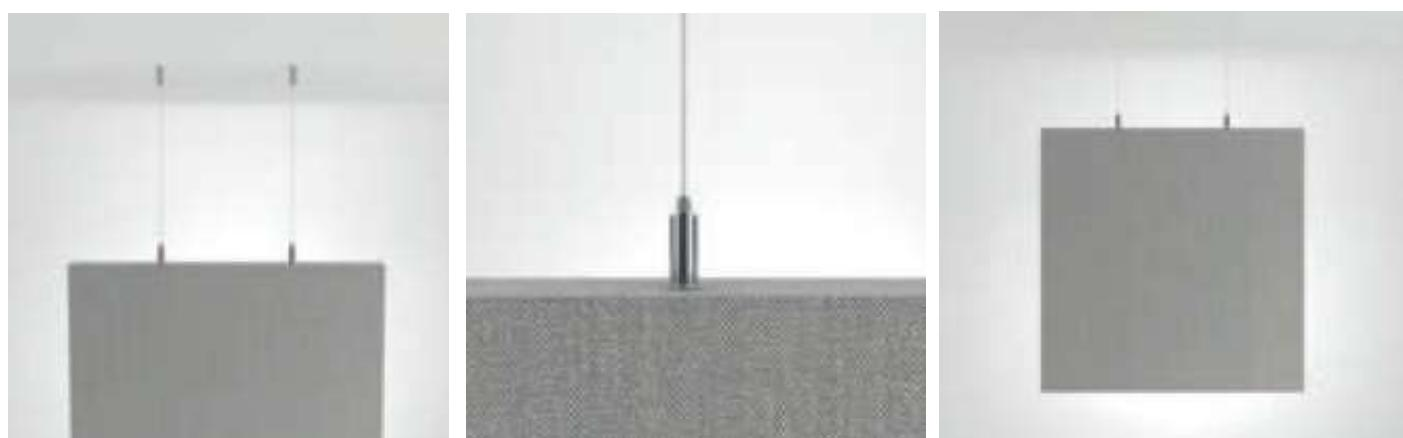
Installare in sospensione verticale dal soffitto (a baffle) mediante cavi in acciaio plastificati, cilindri e morsetti filettati, forniti nel kit di fissaggio. Per questo tipo di installazione, che garantisce la fono-assorbenza su entrambe le facce dei pannelli, i cilindri sono direttamente fissati su uno dei lati esterni del telaio perimetrale rivestito in tessuto.
