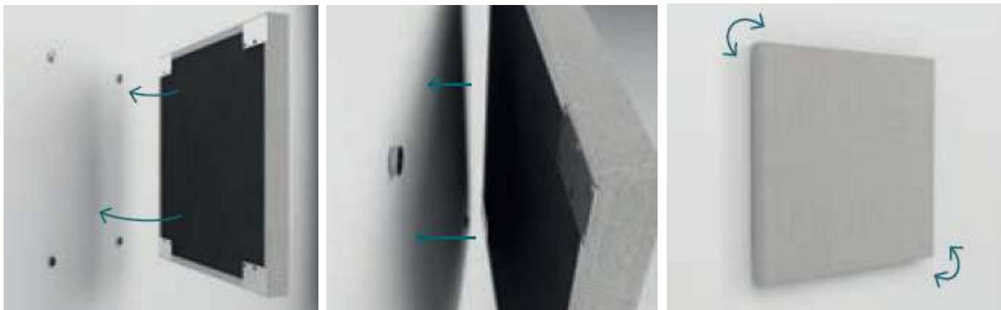
Ciascun pannello della linea Absorber PRO si può installare in aderenza a soffitto e/o a parete mediante un sistema di fissaggio magnetico composto da piastre metalliche e calamite tonde, fornite nel kit di fissaggio. Il kit è composto inoltre da un sistema di sicurezza, fornito con la relativa scheda di sicurezza.
